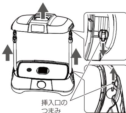
5. 内部に収まるようにカバーを折りたたみ、本機上部と下部をロックで固定します。
