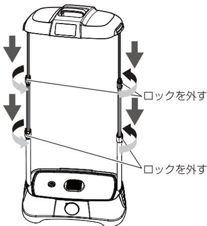
3. 本機上部のポール挿入口のつまみをスライドさせ、本機上部からポールを引き抜きます。
