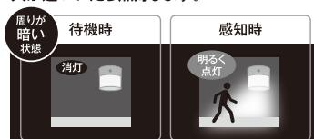
※人感センサーの特性上、周囲の明るさ・周囲の温度変化・動作速度・設置場所などの要因により、センサー感度に差が出ます。
