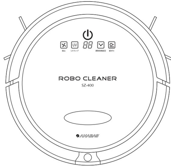
SZ-400 ロボクリーナーはまさに皆様のお手伝いをする掃除ロボットです。SZ-400 ロボクリーナーは5種類の動き、ランダム→スパイラル1→壁沿い→スパイラル1→ジグザグ→スパイラル1→スパイラル2→スパイラル1→ランダムを反復し、壁や家具などの障害物がある場合その壁や家具に沿って動きながら2つのサイドブラシでごみや塵をかき出し、集塵ケース(ダストボックス)に収納します。掃除設定時間内に、この動作を繰り返しながら部屋全体を掃除します。
